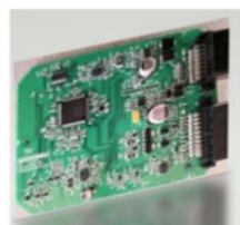
热泵空调控制器
